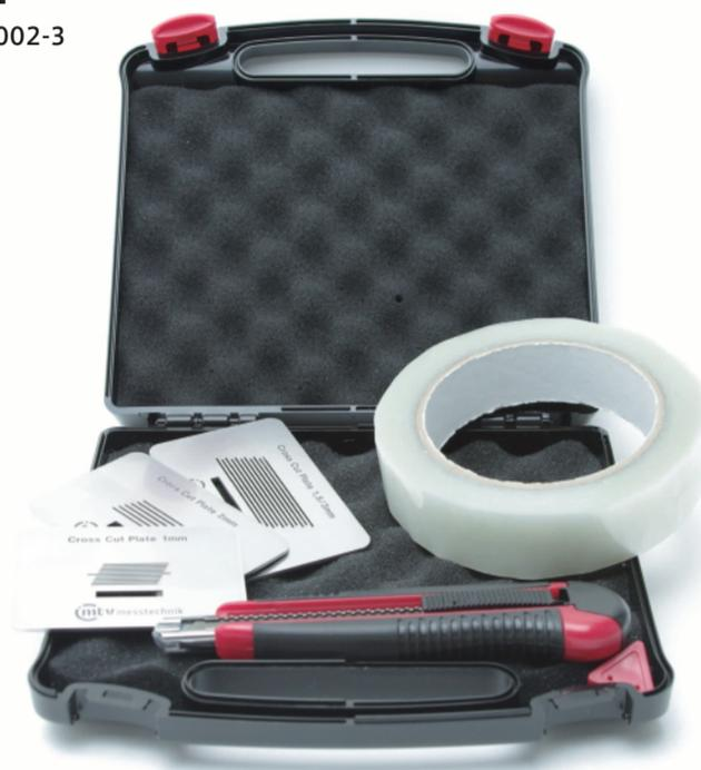
JIS-K5600-5-6で規定されているクロスカット法に使用するクロスカット試験セット。セットには1mm・2mm・1.5mm/3mm間隔で切込を入れることができるクロスカットプレート3枚が付属しています。クロスカットプレート1mmは25マス試験と100マス試験が行えます。クロスカットプレート2mmは25マス試験用。クロスカットプレート3mmは1.5mm×100マスと3mm×25マスの試験が行えます。スムーズに塗膜をカットし、きれいな格子状のクロスカットができます。同じ場所をカットしないように少し斜めにスリットを入れています。程よい厚みと重量で非常に使い心地がよいです。その他付属品としてカッター・クロスカット用25mm幅テープ(66m)が専用ケースに入っています。
