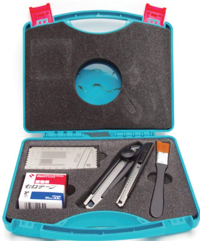
クロスカット試験、碁盤目試験と250 $\mu$ m以上の厚膜に対して付着試験で行うXカット試験(角度30°)も行えるマルチカッターガイド。これ一枚で、1mm間隔 $\times$ 11本(100マス試験)、1mm間隔 $\times$ 6本(25マス試験)2mm間隔 $\times$ 6本(25マス試験)、1.5mm間隔 $\times$ 11本(100マス試験)、3mm間隔 $\times$ 6本(25マス試験)、Xカット試験(角度30°)が可能です。スムーズに塗膜をカットし、きれいな格子状のクロスカットができます。
