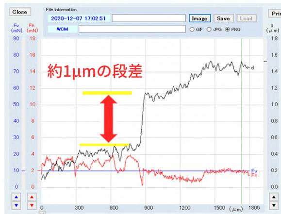
シリコンウエハーの上のレジスト膜（約1 $\mu$ m）の段差測定と摩擦係数測定
