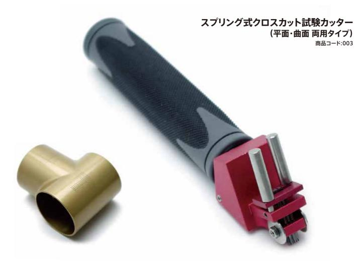
塗膜の付着力・接着力を評価するクロスカット試験(碁盤目試験)が曲面のある製品でおこなえます。これまで曲面では等間隔の切り込みが入れられず、クロスカット試験が行えませんでした。スプリング式クロスカット試験カッターを使うと、平らなテストピースでの評価だけでなく、実際の製品でクロスカット試験がおこなえますので、品質の向上に繋がります。パイプ状のものであれば最小直径Φ40mmまで切込可能。先端には多重刃が付いており、塗膜に対して一度に6本の切込を入れることができます。平面と曲面の両方に使用できます。ラインナップは1mm間隔6本(25マス試験)・2mm間隔6本(25マス試験)・1mm間隔11本(100マス試験)があります。
