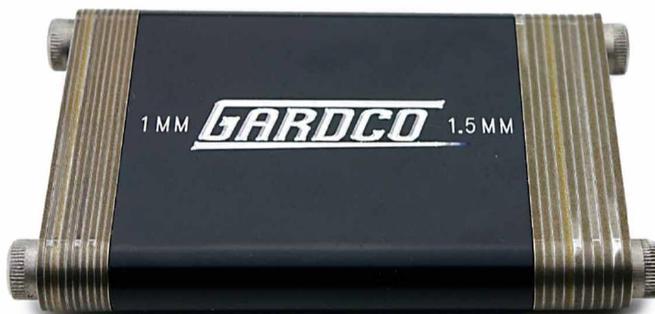
IS-K5600-5-6で規定されているクロスカット法 等間隔スペーサー。1mmの厚みのスペーサー(間隔刃)10枚がついています。反対面には1.5mmの厚みの間隔刃10枚がついており、1mm・1.5mm・2mm・3mm・4mm・4.5mm・5mm・6mm間隔のクロスカット試験・基盤目試験がこれ一枚で全て行えます。
