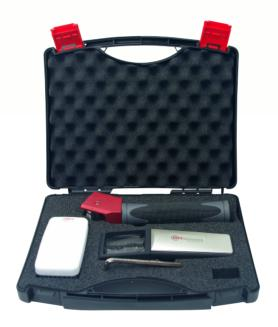
クロスハッチカッターの刃が消耗した場合に回転させることにより新しい刃で試験が行えます。刃は全部で6枚分(6エッジ)あります。クロスカット試験マスターと併用して使用できますので、現場では手持ちタイプ、試験室では卓上式のクロスカット試験マスターというように使い分けすることができます。
