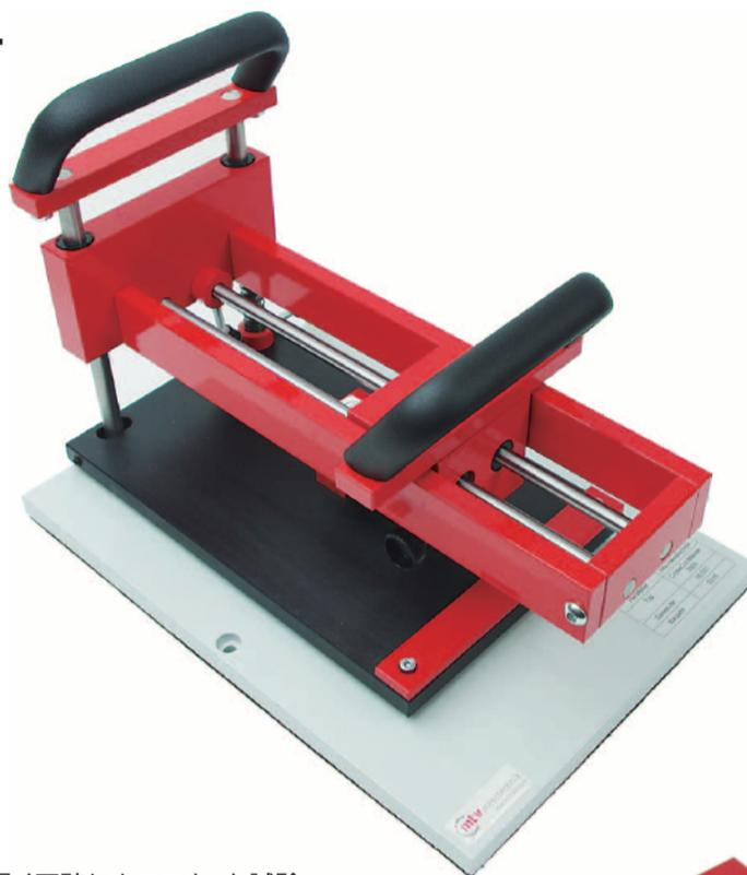
クロスカット試験マスターは、卓上で素早く正確にクロスカット試験を行うために開発された手動装置です。アタッチメント部分に回転式スベアカッターをセットし、一度に均等なカットができるように工夫されています。1mm.2mm.3mm間隔×6本刃(25マス試験)、1mm間隔×11本(100マス試験)の各種スベアカッターがセットできるため、カッターを交換することにより、1mm.2mm.3mm間隔の全ての試験が行えます。
