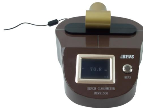
小さな製品や曲面の光沢度を測定できる小面積ピンポイント光沢計です。測定に必要な面積はわずか2mm×2mm。本体上部のステージに測定穴(4mmφ)が空いており、その上に測定対象物を置きます。測定穴がきちんと塞がれていれば光沢度が測定可能です。付属品のフットペダルは、不安定な形状の物も両手で持ちながら足でペダルを踏んで測定する事ができます。その他、赤外線センサーも付属しており、センサーに手をかざすだけで測定が行えます。液晶タッチパネルディスプレイにより感覚的に操作が行えます。自動校正機能搭載。
