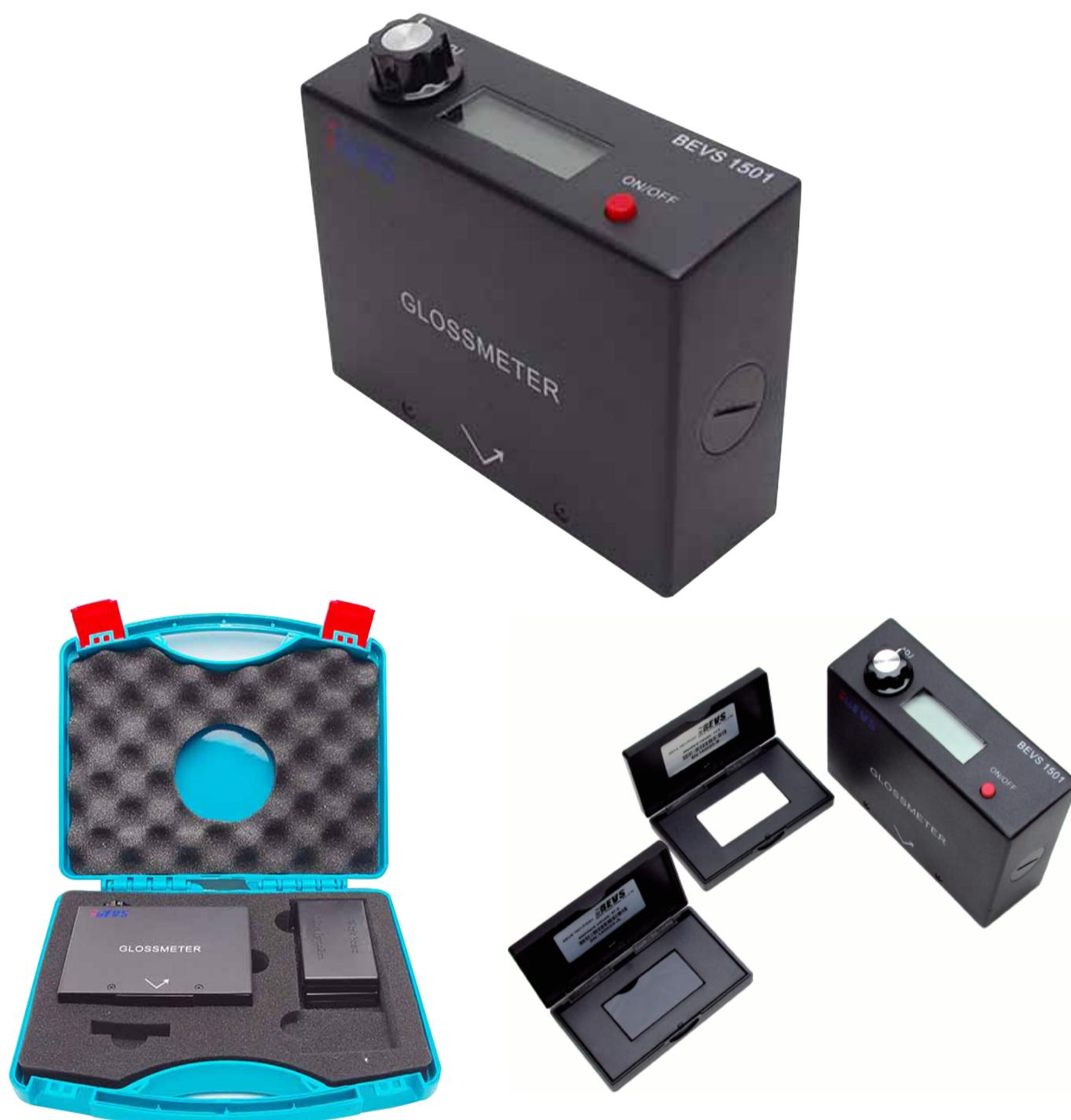
塗膜・インク・プラスチック・石・紙・タイル・エナメルなどの表面の光沢度を測定するために使用する60°光沢計です。一般には60°鏡面光沢度で塗装面の光沢の良否を定量評価しています。JIS-K5600には60°の角度は全ての塗膜に対してに適用できると記載されています。光沢不良は、顔料分散の不十分・膜厚の過多及び不足、乾燥状態など様々な要因で発生します。また塗装面の仕上がり状態を、つや有り、3分つや、つや消しなど感覚的な表現で指示・管理をするのではなく、つやの程度を定量的に管理するために光沢計を使用します。
