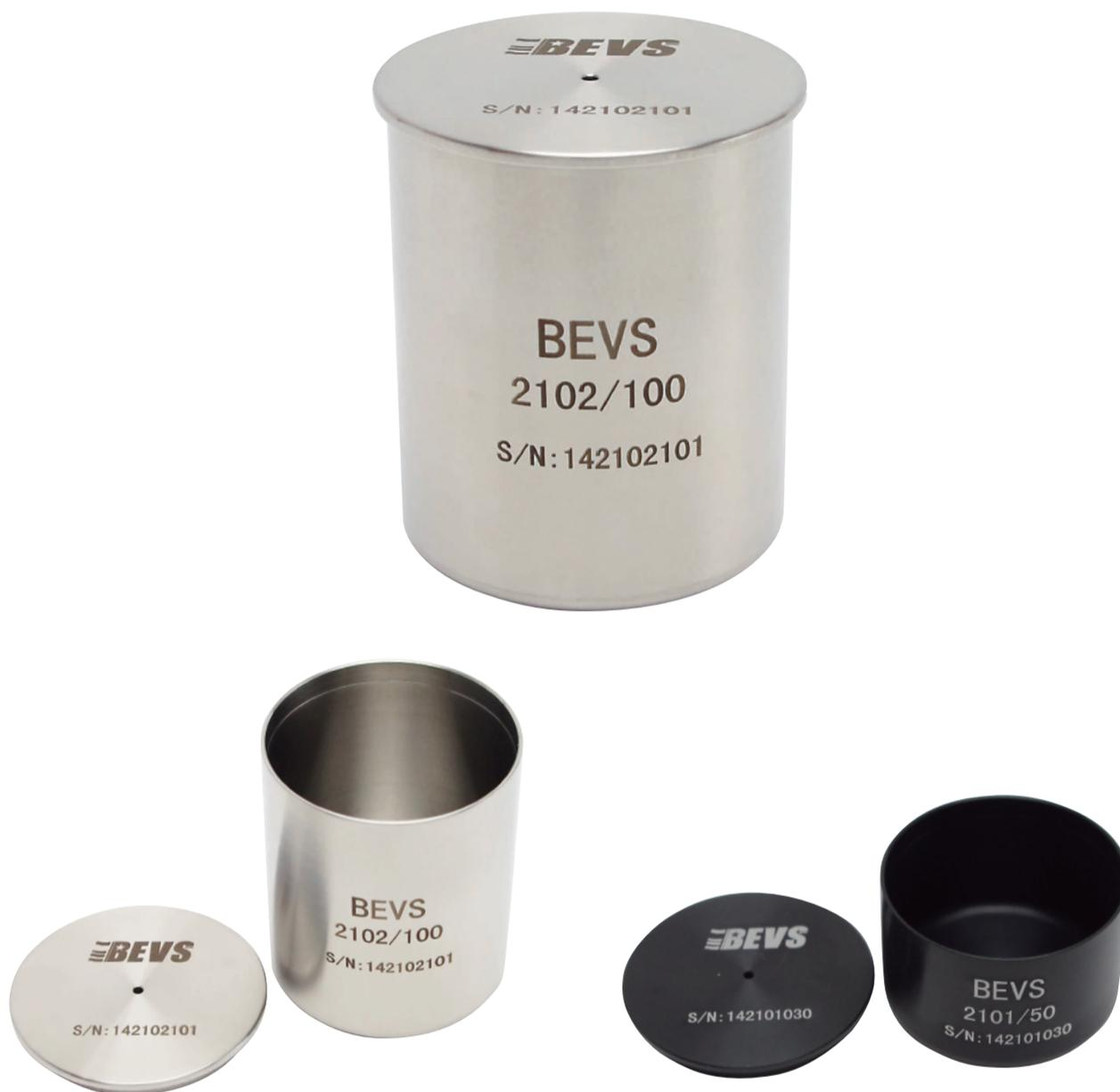
塗料やその関連製品の密度を測定するために使用する金属製の比重カップ(金属製比重瓶)です。金属製ピクノメータと呼ばれています。容量は50cm<sup>3</sup>(ml)・100cm<sup>3</sup>(ml)・83.3cm<sup>3</sup>(ml)があり、材質はアルミ製・ステンレス製があります。
