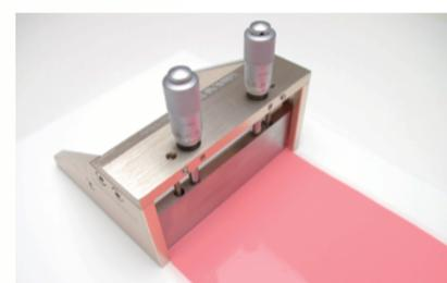
塗布する膜厚をマイクロメーターで調整できるフィルムアプリケーター。0～3500 $\mu$ mまですき間が自由に変更できます。マグネット式スクレーパーはすぐに取り外しが行えますので、ご使用後の洗浄が非常に簡単です。また、B/Mタイプは塗料流し込みガイドが付いており、スクレーパー手前に塗料(試料)の液だまりを作ることで塗工中も塗料が常に供給され、途切れの無いより安定した塗工が可能になります。塗料流し込みガイドも取り外しが簡単なため洗浄が簡単に行えます。塗布幅は50・100・150・200・250・300mm。1目盛り10 $\mu$ m刻みで可変が行えます。
