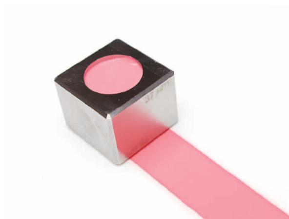
アプリケーター内に液だまりをつくることで塗布幅からはみ出さず幅に合わせた塗膜をつくれます。塗幅も16mmと細く塗布したい場合に使用します。塗布する量を一定にしたい場合や、高価なコーティング剤などで歩留まり良くテストピースを製作したい場合などにも使用されています。また、塗膜乾燥時間測定機(ドラインタイムレコーダー)のガラスプレートに試料を塗布するために使用されます。
