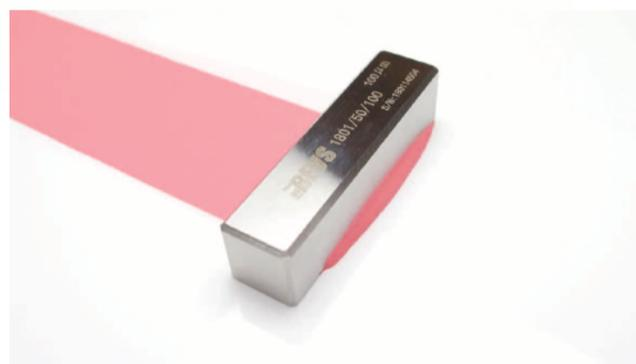
ドクターブレードフィルムアプリケーターは、金属ブロックの片面を加工して「すき間」をつくり、塗料やインクなどを一定の膜厚で塗布することができます。アプリケーターを使用すると、高精度で再現性の高い塗膜ができ、安定した膜厚が得られます。塗布幅は50mmと75mm。すき間は、50・75・100・125・150・200μmがあります。材質はステンレス製。
