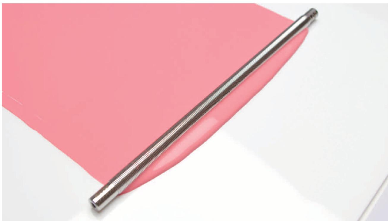
塗料やインクなどを一定の膜厚に塗布するために使用されるバーコーター。一般的なバーコーターはワイヤーが巻かれており、ワイヤー切れや、隙間に塗料が詰まってしまうなど洗浄も大変でした。このバーコーターはワイヤーを巻いているのではなく、バー自体に膜厚に合わせた均一な凹凸の加工をすることによりワイヤー切れやワイヤーずれも無く、洗浄についても改善されました。消耗も少ないためより長く使用できる新型のバーコーターです。膜厚は $\mu\text{m}$ 単位です。6~200 $\mu\text{m}$ の中から選択して下さい。塗布幅は200mmと320mmがあります。
