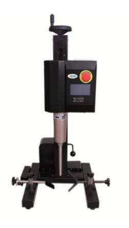
試作品の塗料、小ロットの塗料の攪拌に使用できる塗料用ラボミキサー。 $1.5~\ell\sim 20~\ell$  までのステンレス製容器とそれぞれの容器の大きさに合ったディスクタービン(回転翼)を自由に選べます。攪拌したい容量に合わせてご選定下さい。「ラボ用ミキサーでは小さすぎる」「生産ラインを動かすまでの量ではない」という場合に適正な量の塗料を撹拌できます。液晶タッチパネル操作で撹拌スピード (rpm)、撹拌時間を自由に調整できるデザインのインペラ式撹拌機です。インペラの鋸歯形ディスクタービンは、不溶性の乳化、エマルジョン化、微細化、せん断混合、高粘度液や高濃度スラリー液の撹拌などに有効です。最大回転数9000rpmと高速回転が可能なため、鋸歯形ディスクタービンにより強力な流体せん断が得られます。主にコーティング剤、塗料、インク、顔料、化粧品、食品、樹脂、接着剤、ラテックス、医療、接着剤、その他の分野で顔料分散、液体混合、かき混ぜなどに使用されています。
