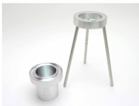
ASTM規格に準拠したフォードカップ(FORD CUP)・ISO規格に準拠したISOカップのご紹介です。塗料やインクの粘度を測定するのに使用します。オリフィス径の違いにより測定する粘度の範囲が異なります。カップ本体はアルミ製で、ノズル部分はステンレスを使用しています。フォード・ISOカップ専用水準器付スタンドもございます。
